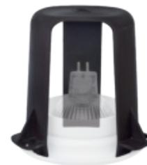
**Abstandhalter für Hohldecken** | nicht brennbarer - glasfaserverstärkter Kunststoff, für Bohrungen von Ø 62 bis Ø 90, verlängert die Lebensdauer der Leuchtmittel, verhindert direkten Kontakt zur Isolierung
