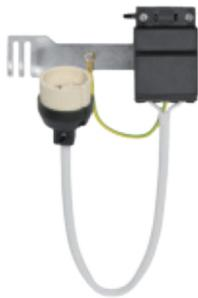
**Umrüstsatz von NV auf HV** | mit wärmebeständiger Gewebeisolierung, Distanzstück L 100, mit Erdanschluss, feststehendes Anschlussgehäuse, mit Zugentlastung und Klemme 3 x 2,5 mm<sup>2</sup>, isolierte Fassung
