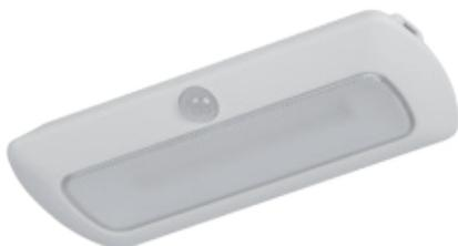
**Akku-Sensorleuchten** | Kunststoff weiß, mit Prismenabdeckung klar, mit Bewegungsmelder, Reichweite 3 m, Zeit 20 Sekunden und Dämmerungsschalter, mit Schalter Ein/Aus/Auto, inkl. LI-ION-Akku, Klebeband, Magnethalter und USB-Ladekabel, LM nicht wechselbar
